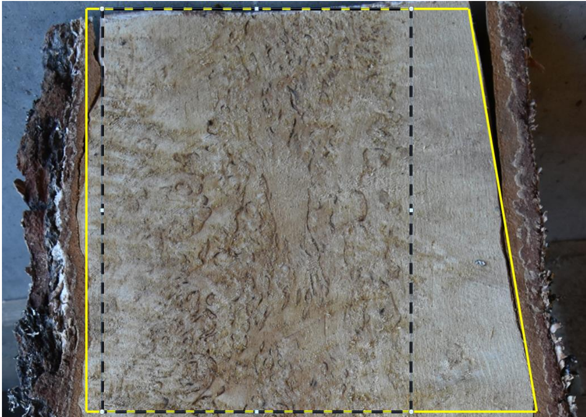
Kuva 6. Visapuun pinta-alan mittaaminen. Keltainen puolisuunnikas kuvaa koko lappeen kuoretonta pinta-alaa (5,289 pinta-alayksikköä) ja mustalla katkoviiva erotettu neliö visapuun arvioitua pinta-alaa (3,894 pinta-alayksikköä), jolloin visan pinta-alan prosenttiosuus on 73,6. (Kuva: Heikki Korpunen)
